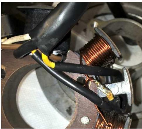
Sollte sich der Isolierschlauch trotz Erwärmung nicht bewegen lassen, dann muss er halt von der Spulendraht-Seite her vorsichtig Stück für Stück aufgeschnitten werden, bis die gesamte Lötstelle -wie links im Foto zu sehen- freigelegt ist.
