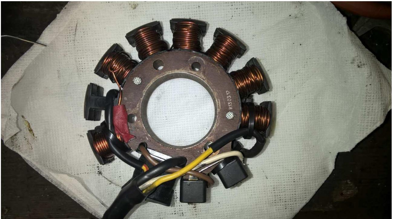
Abschließend kannst du den Stator wieder (entsprechend deinen Markierungen) auf die Grundplatte aufsetzen.
