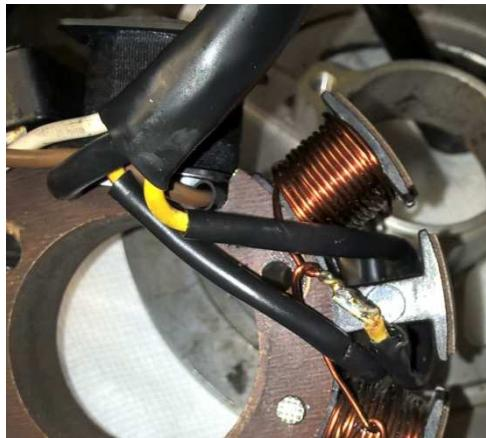
Versuche nun den dicken Isolierschlauch der Kabdurchführung vorsichtig in Richtung „leeren“ Spulenanker zu drücken, so dass gelb lockerer zum Liegen kommt.
