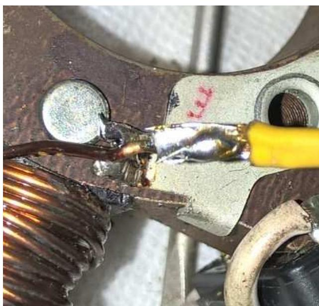
Das Ende des gelben Kabels soll nun mit dem freien Ende der Lichtspule auf „gegenläufigen Stoß“ verbunden (verlötet) werden.
